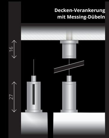
Der Drachtseilhalter wird mit einem 1,5 mm dicken Drahtseil in beliebiger Länge am Deckenbefestiger aufgehängt, max. Belastung pro Halter 25 kg.
